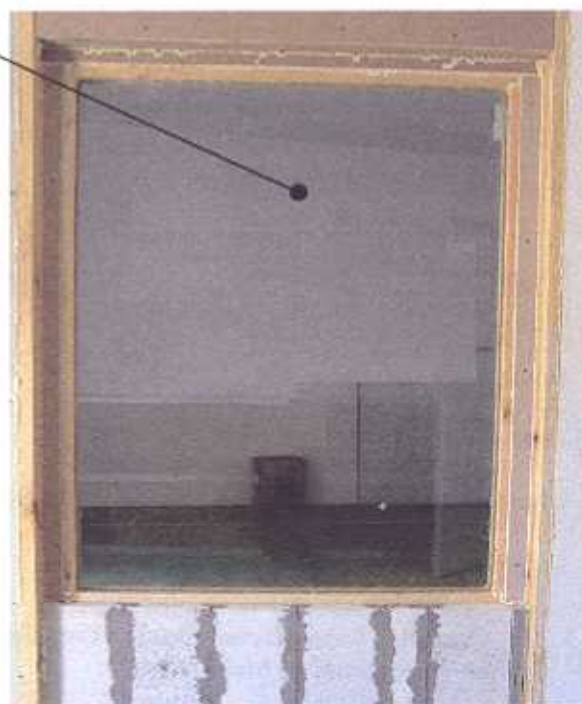
Zdjęcie nr 2 Pakiet szklany typu 3.3.1 x 16WES (Argon) x 4.4.4 na stanowisku badawczym (widok od strony komory odbiorczej)
