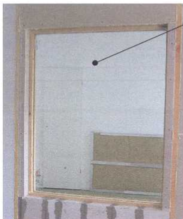
Zdjęcie nr 1 Pakiet szklany typu 3.3.1 x 16WES (Argon) x 4.4.4 na stanowisku badawczym (widok od strony komory nadawczej)
