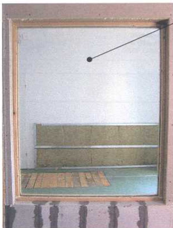
Zdjęcie nr 1 Pakiet szklany typu 3.3.1 x 16WES (Argon) x 3.3.1 na stanowisku badawczym (widok od strony komory nadawczej)
