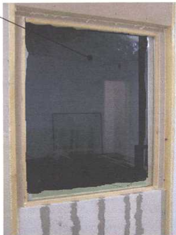
Zdjęcie nr 2 Pakiet szklany typu 3.3.1 x 16WES (Argon) x 3.3.1 na stanowisku badawczym (widok od strony komory odbiorczej)
