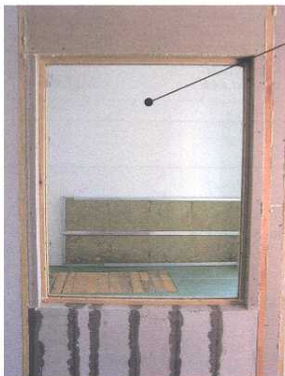
Zdjęcie nr 1 Pakiet szklany typu 4 x 16WES (Argon) x 6 na stanowisku badawczym (widok od strony komory nadawczej)
