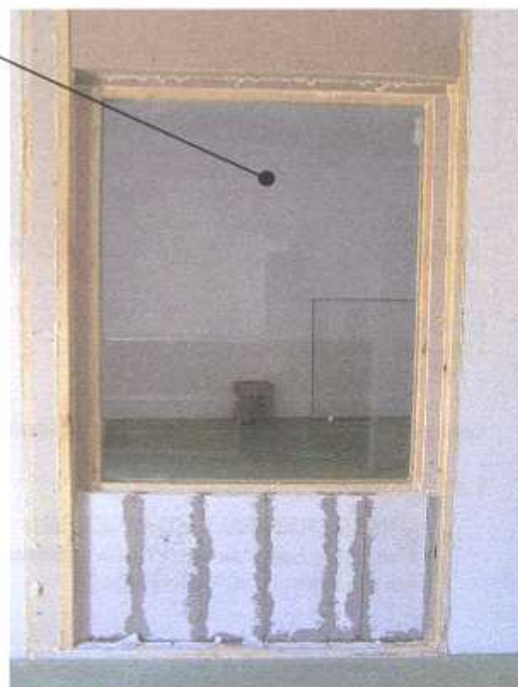
Zdjęcie nr 2 Pakiet szklany typu 4 x 16WES (Argon) x 6 na stanowisku badawczym (widok od strony komory odbiorczej)
